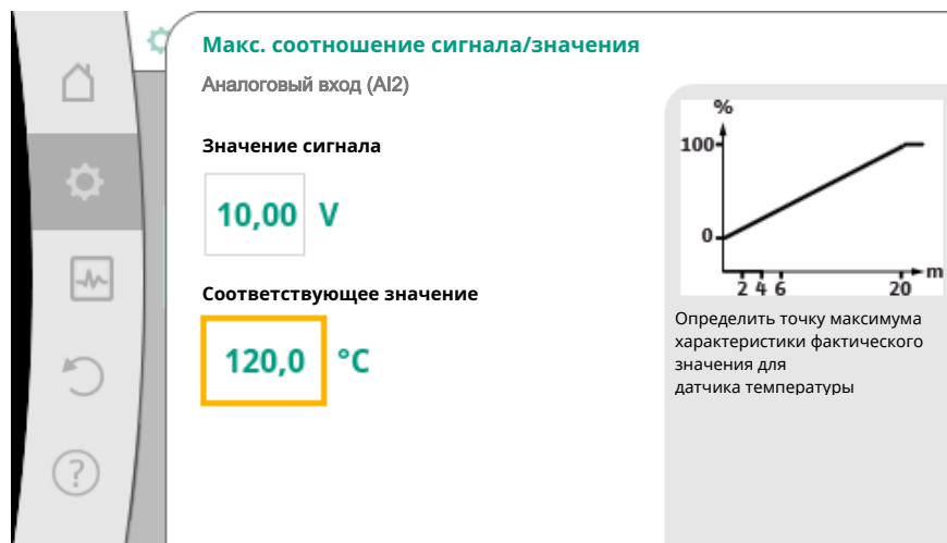
Fig. 86: Макс. соотношение сигнала/значения, датчик фактического значения Ввод минимальных и максимальных опорных точек характеристики завершает ввод.
