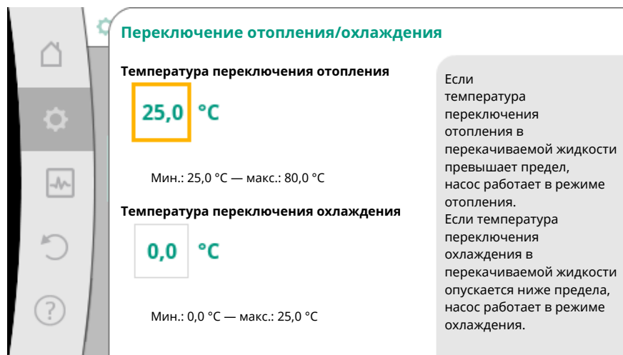
Fig. 51: Переключение отопления/охлаждения_Температуры переключения
